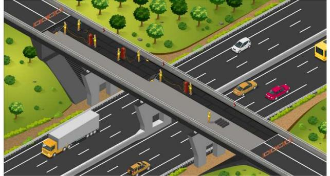
Pose de la nouvelle structure d'étanchéité et remplacement des joints de chaussée
